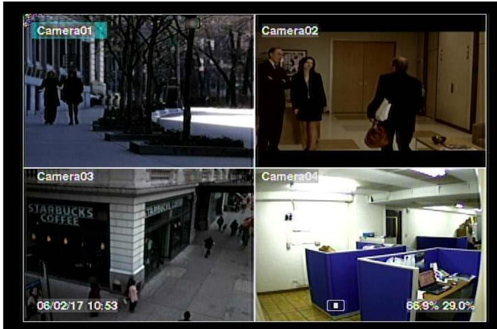
系統開機後，主畫面將顯示如上圖所示之分割視窗。本系統提供多種分割視窗，包括 1-視窗，4-視窗，7-視窗，以及 9-視窗。若系統經由正常關機程序關機(如 [5.7 節](#) 所述)，本系統開機後將回到關機前之分割視窗畫面。除了分割視窗之外，系統時間顯示於畫面左下角，系統狀態顯示於畫面右下角，事件發生之跑馬燈訊息顯示於畫面下方。
