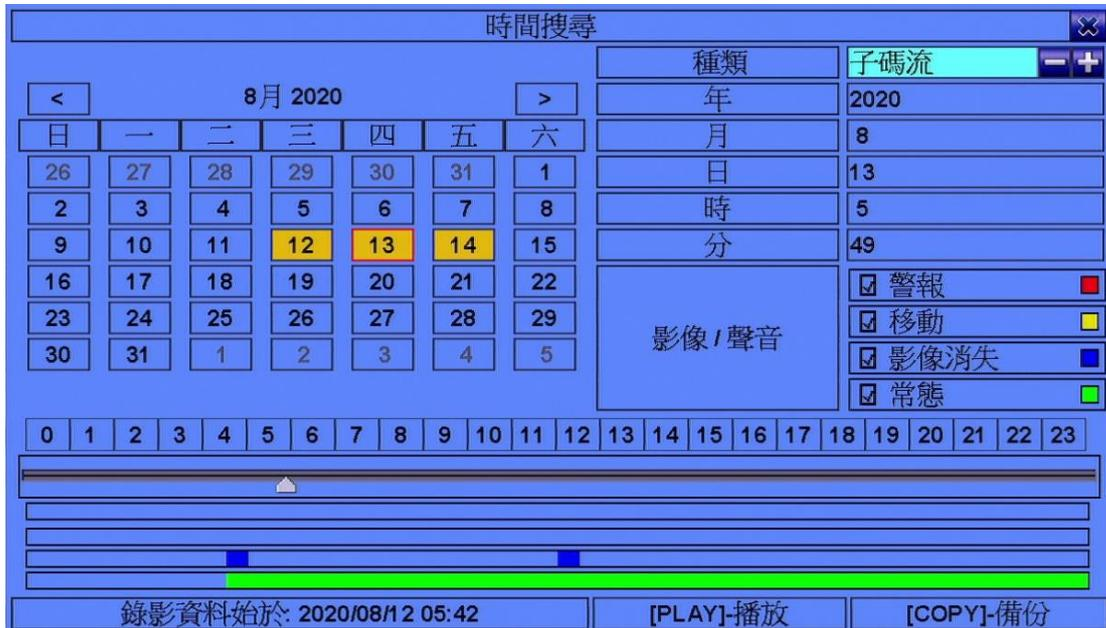
搜尋前，搜尋結果欄將顯示警報錄影(若警報、移動、或影像消失為選取)或常態錄影(若常態為選取)資料之啟始時間，其上則由上至下顯示當日 24H 時間軸及其滑動軸，警報/移動/影像消失/正常錄影狀態。
