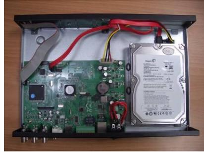
3. 使用螺絲起子固定硬碟，如圖所示。
