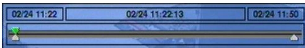
回放滑動軸最左側為啟始時間及其滑動軸，最右側為結束時間及其滑動軸，中間為目前回放時間及其滑動軸。以下為回放滑動軸畫面之使用者操作敘述：
