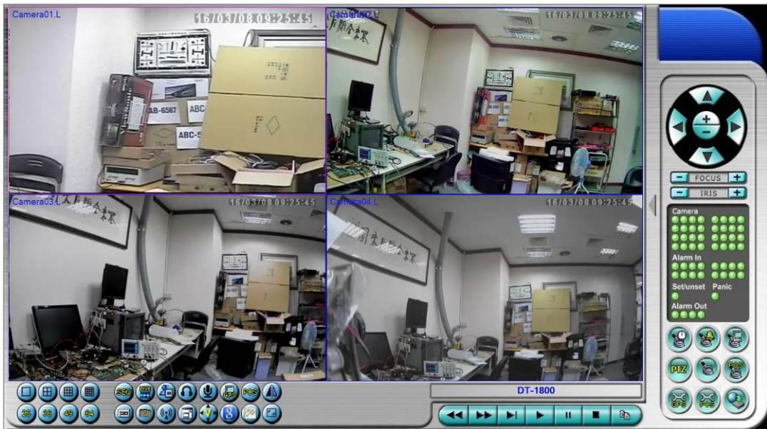
本機之遠端存取提供單一 **DVR1/4/9/16**-視窗畫面、以及多台 **DVR25/36/49/64**-視窗畫面於螢幕上。焦點視窗以附加外框表示。除了影像視窗外，畫面下方與右邊尚有各種圖像，提供狀態顯示與控制功能。
